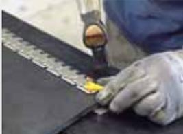
1) Squadrare la testata e collocare la giunzione adattandola allo spessore del nastro; applicare i chiodi nella testata posta su una piastra metallica
