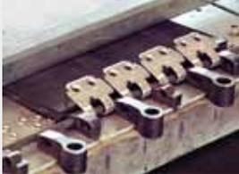
1) Squadrare la testata, collocare la giunzione nell'apparecchio e sistemare la testata nella giunzione
