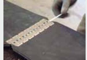
5) Ripetere le precedenti operazioni sulla seconda testata, sovrapporla con la prima ed infilare l'apposito cavetto di fissaggio
