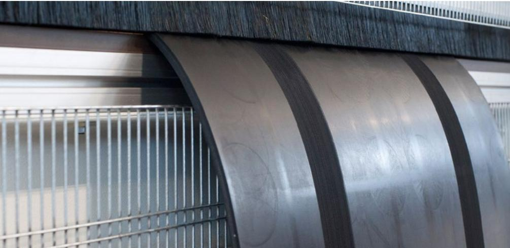
UNIRIGID ist ein spezielles Förderband, dessen eigens hierzu entwickelte Längs- und Querrichtung dem Band Starrheit in Querrichtung und Flexibilität in Längsrichtung verleiht.
