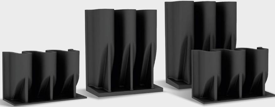
Die Wahl der Seitenwand hängt von der Wahl der Stollen ab. Die Seitenwand muss immer höher als der Stollen sein – entsprechend dieses Parameters kann der Becher eine Textilversteifung aus EP im Innern aufweisen oder nicht. Unsere Seitenwände werden aus einer qualitativ hochwertigen Gummimischung hergestellt, die gegen Ozon und Witterungseinflüsse beständig ist, sehr elastisch ist, eine hohe Bruchlast und eine gute Abriebbeständigkeit aufweist.
