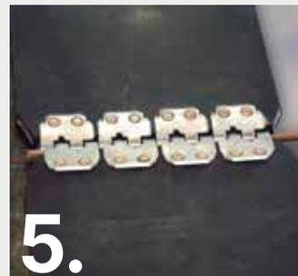
5. Ripetere le precedenti operazioni sulla seconda testata, sovrapporla con la prima ed infilare l'apposito cavetto di fissaggio assieme alle rondelle.
