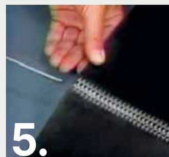
**5.** Unire i due pezzi e inserire il cavetto per collegare la giunzione.
