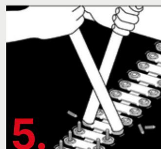
5. Eliminare le parti in eccesso con l'apposita attrezzatura/un flessibile.
