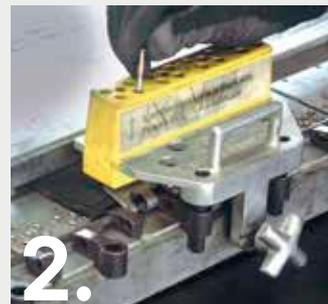
2. Posizionare la macchinetta per l'applicazione dei rivetti, inserire poi i rivetti all'interno.
