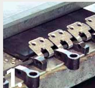
1. Squadrare la testata, collocare la giunzione nell'apparecchio e sistemare la testata nella giunzione.
